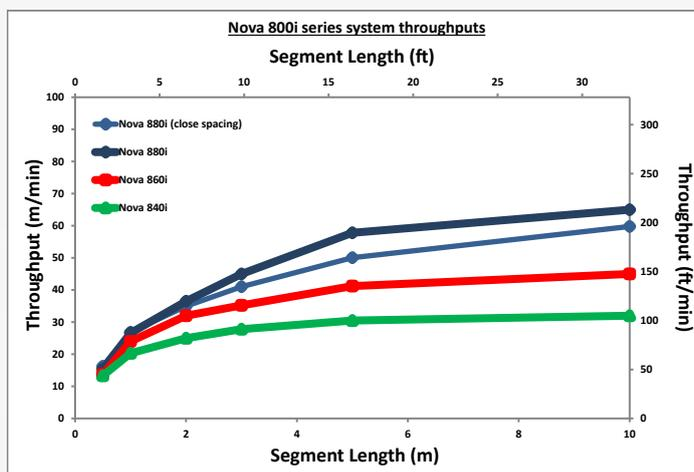
注: Nova840i和 Nova 860i在标印商用宽间距和军用短间距的生产率相同, 而Nova 880i在标印商用宽间距的速度略高
