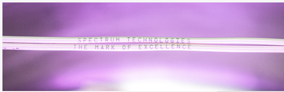
以上: 紫外激光标印的线缆
